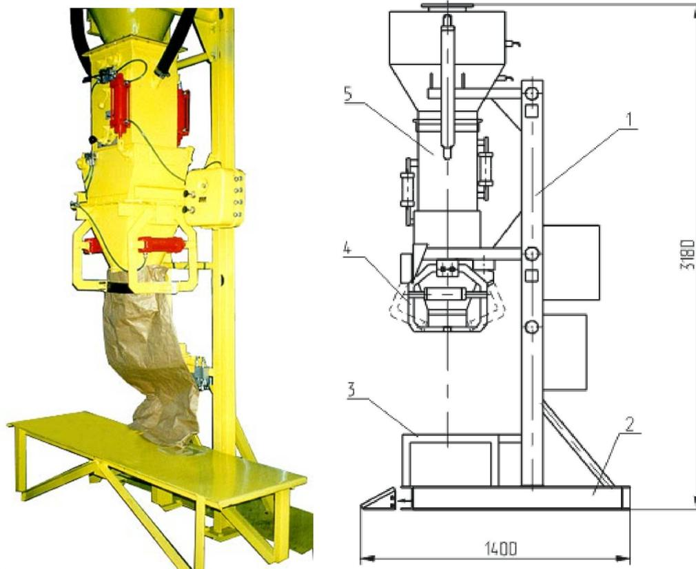
Все части агрегата собраны на вертикальной стойке, установленной на раме. Фасуемый материал из расходного бункера самотеком поступает в дозатор, снабженный верхними и нижними поворотными заслонками, управляемыми пневмоцилиндрами. Перед началом фасовки открываются верхние заслонки и материал заполняет объем дозатора, после этого верхние заслонки закрываются, а нижние открываются и доза материала высыпается в мешок, установленный на столе и закрепленный с помощью прижимов на приемной горловине.
